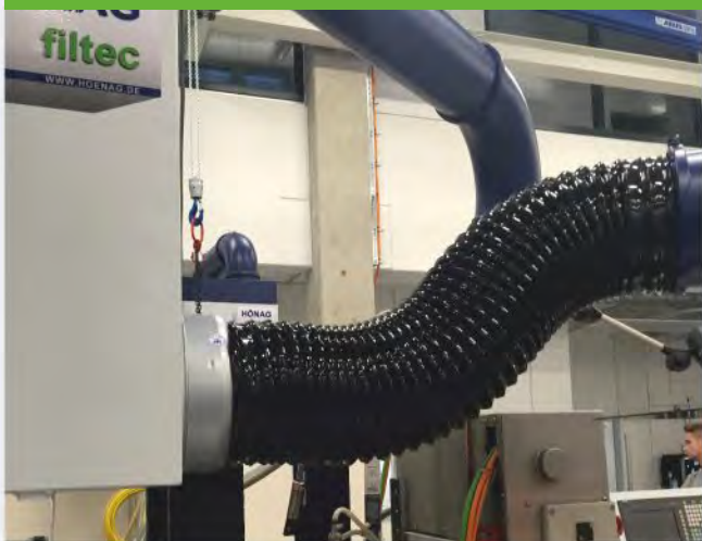
Absaugung und Rückführung an offener Flachsleifmaschine
